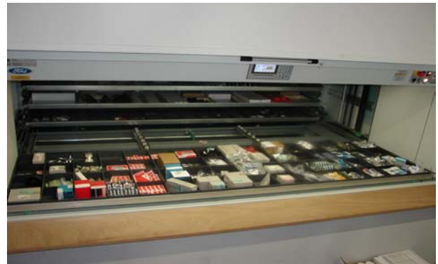
L'accès aux pièces par l'ouverture Shuttle attenante à l'atelier
